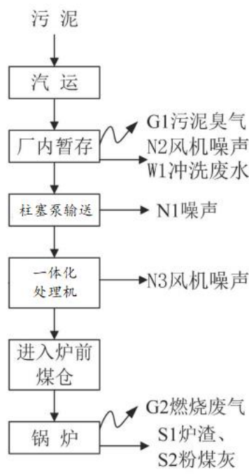
图 3.2-1 本项目工艺流程与产污环节
