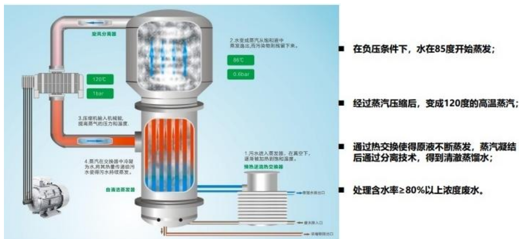
图 3.2-3 厂内污水处理装置工艺原理图
